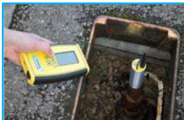
Pour exemple, le cas ci-après où l'on distingue en jaune le capteur ayant enregistré un bruit anormal sur les canalisations situées à proximité. Cette indication nous a permis de lancer une intervention de recherche par méthode acoustique au sol et de trouver une fuite sur un branchement.
